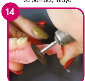
14 Odcinanie kanałów wlewowych za pomocą tarczki
