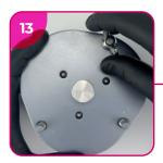
Затянуть винты рамы для перебазировки и полимеризировать в течение 30 минут при температуре 65°С и давлении 2 бар.
